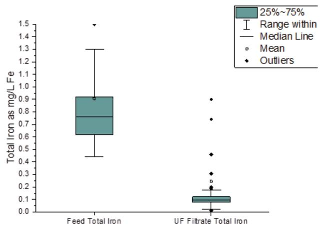
Fig. 8. Feed and UF filtrate total iron.
