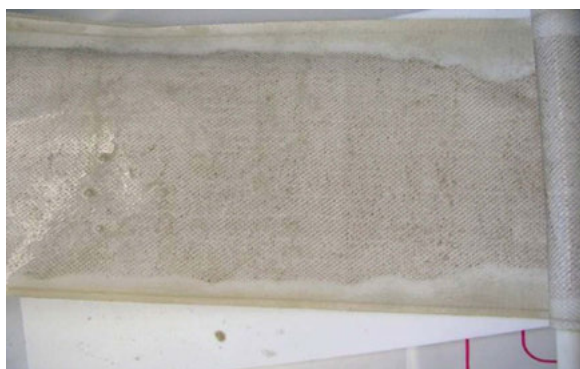
Fig. 11. DBNPA treated BW30XFR.
