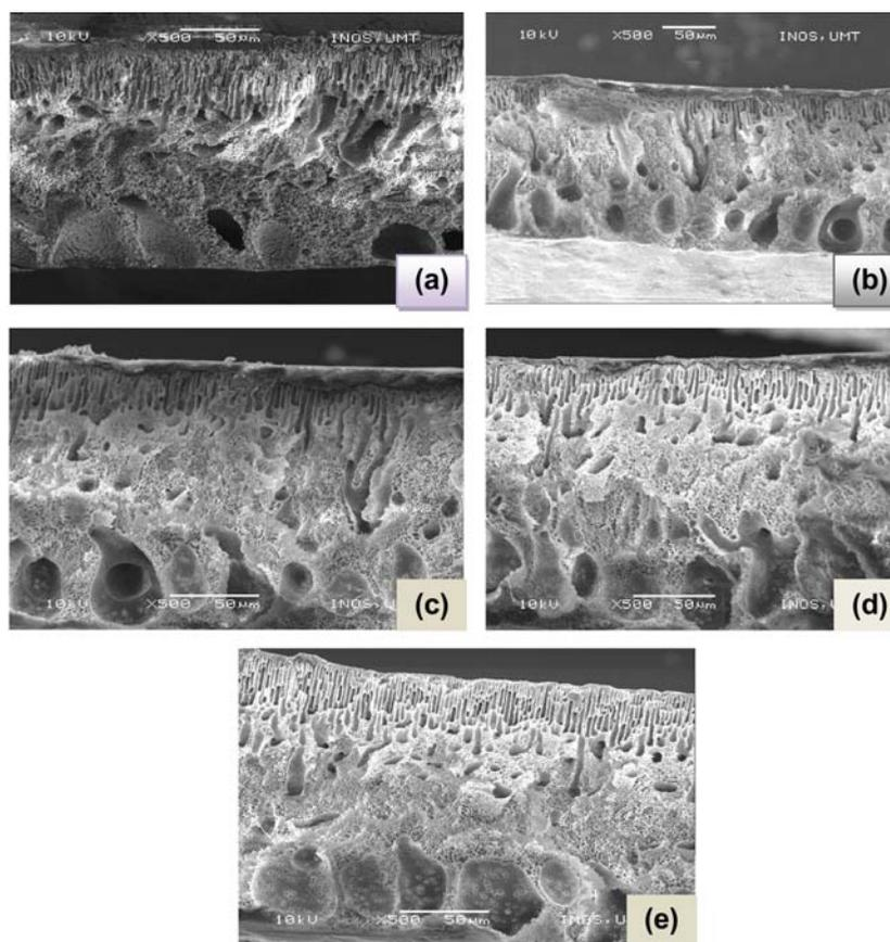
Fig. 2. SEM (500 $\times$ ) cross sectional image of membranes: (a) native, (b) MPH7, (c) MPH5, (d) MPH9, and (e) MPH11.
