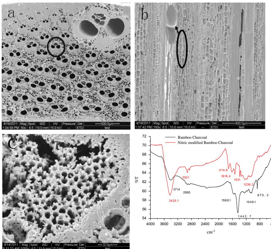
Fig. 2. Scanning electron micrograph and FTIR spectra of modified Bamboo Charcoal (a)  $\times 50$ ; (b)  $\times 100$ ; (c)  $\times 1,000$ ; (d) FTIR.
