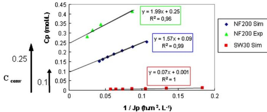
Fig. 11. Evolution de la concentration en perméat en fonction de l'inverse du flux de perméat (NF200 en simulation et expérimentation; SW30 en simulation).
