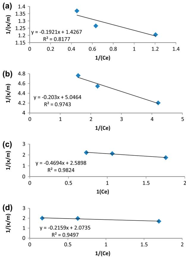
Fig. 4. Langmuir isotherm regression for (a) Fe, (b) Mn, (c) Ni, and (d) Cd.
