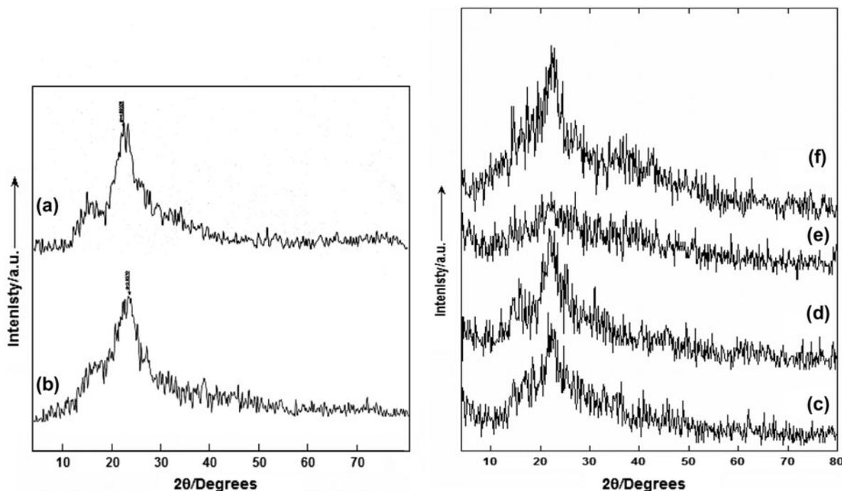
Fig. 3. XRD of (a) SCB, (b) BP, (c) SCB-Pb(II), (d) SCB-Na(I), (e) BP-Pb(II), and (f) BP-Na(I) phases.
