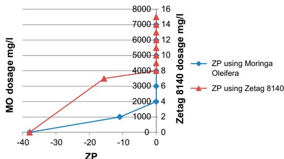
Fig. 5. ZP using single polymer.
