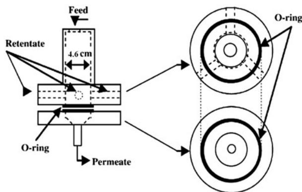
Fig. 1. Membrane module.
