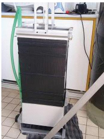
Fig. 5. Flat-sheet module.
