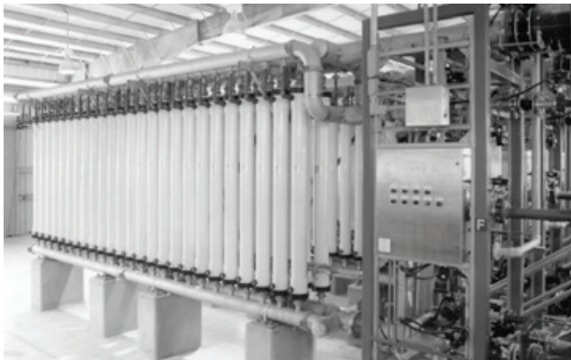
Fig. 20(b). Microza hollow fiber UNA modules [38].
