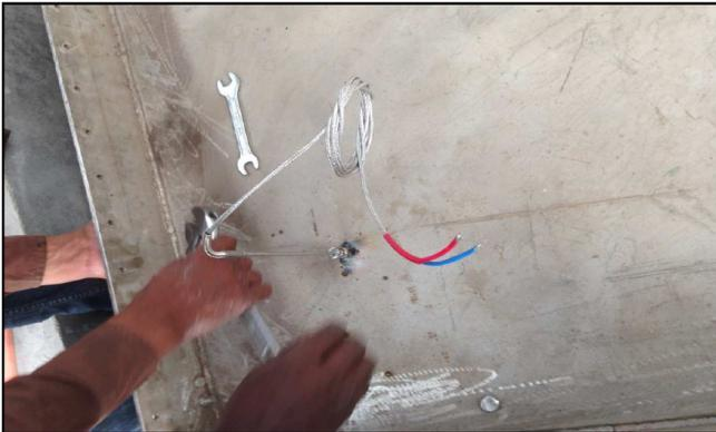
Fig. 10. k-Type thermocouple (steel type).
